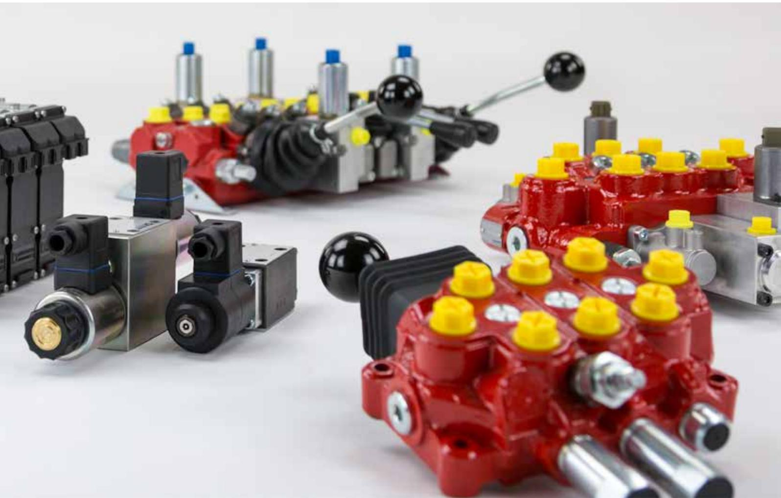
Wege-Schieberventile werden als Steuerungs- und Sicherheitssysteme für die Arbeits- und Fahrhydraulik von mobilen Arbeitsmaschinen eingesetzt. Hierzu gibt es je nach Anforderung unterschiedliche Bauformen und Funktionselemente wie Druckwaagen, Druckbegrenzungen, Sperr-, Schock- und Stromventile und viele andere mehr.
