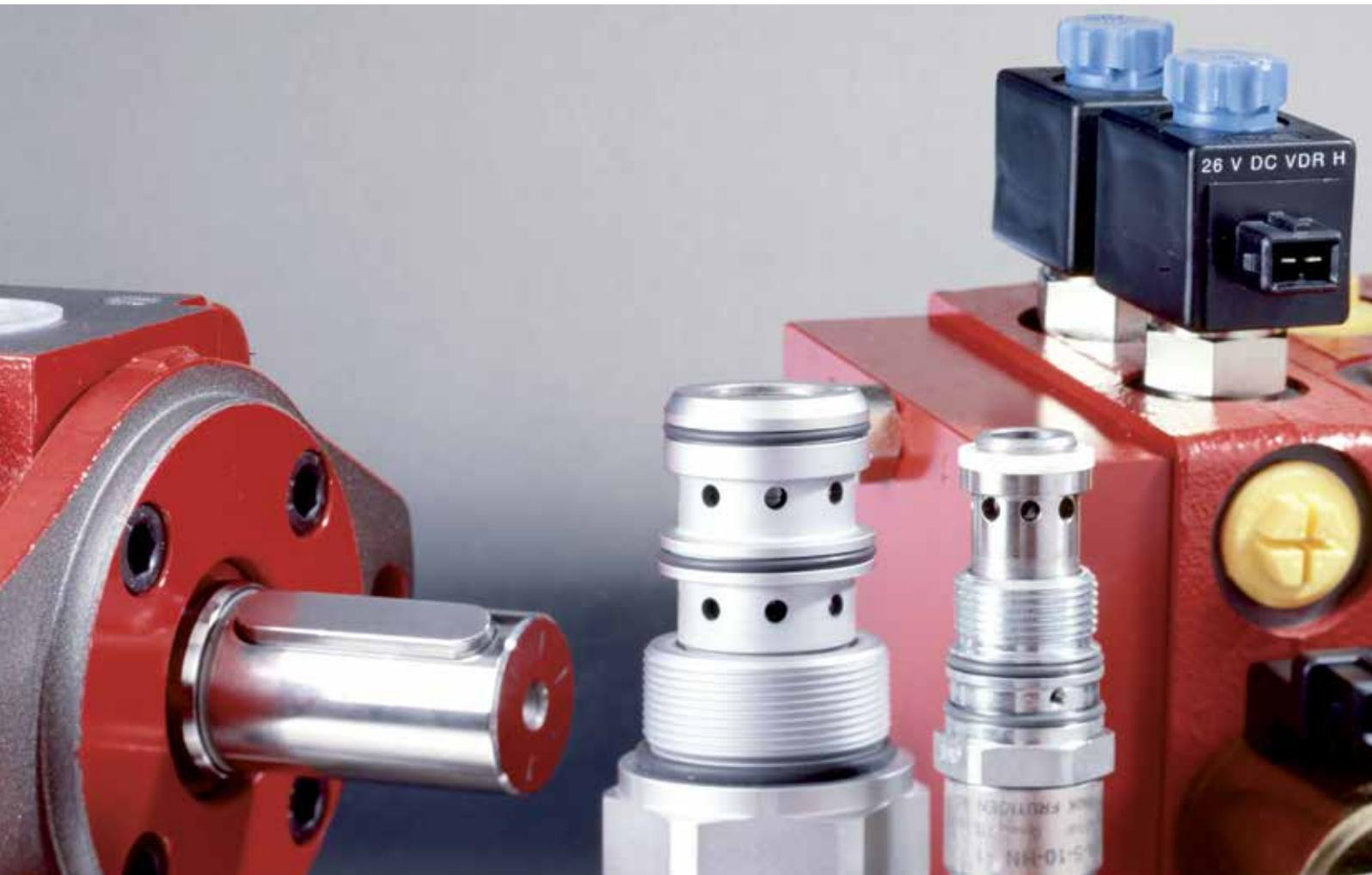
Diese Ventile in Leichtbauweise (Aluminium) dienen zur Steuerung einfach- oder doppelwirkender Verbraucher. Sie werden dann eingesetzt, wenn hohe Anforderungen an die Dichtheit gestellt werden. Es sind direktgesteuerte 2/2-Wege Doppelsitzventile mit magnetischer Betätigung. Sie dichten den Zu- bzw. Rücklauf von hydraulischen Verbrauchern nahezu leckölfrei ab.
